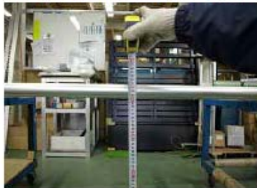
〈除荷後たわみゼロ(残留変位なし)〉
