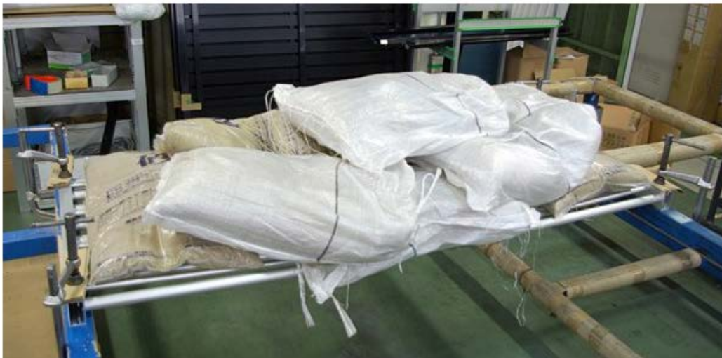
【3】水平に置き両端部を固定し、パネル全面に荷重を加える
