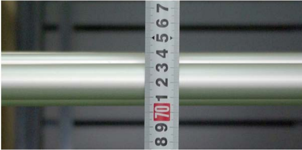
【2】荷重袋を使用して変位量を測定(18kgの砂袋を1袋づつ等分布で積載)
