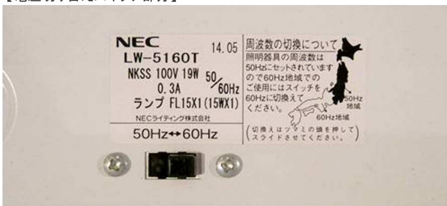
【電圧切り替えスイッチ部分】
